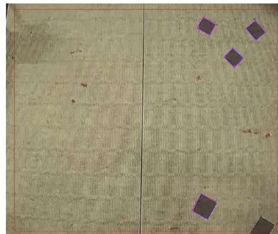
Инспекция (мониторинг) поверхности минватного полотна
