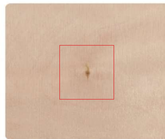
Автоматическое определение дефектов на поверхности фанеры и шпона
