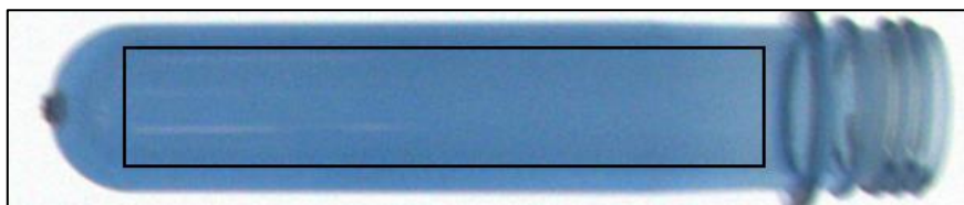
Рисунок 4. Преформа и центральная часть (ядро преформы)
